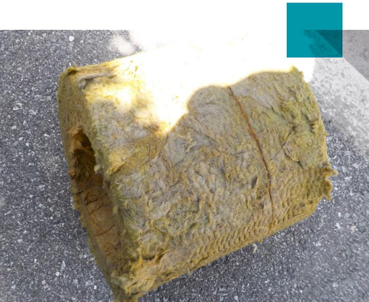
ROCKWOOL WR-Tech Dämmung nach 3 Jahren bei einer Betriebstemperatur von 120°C - 140°C.
