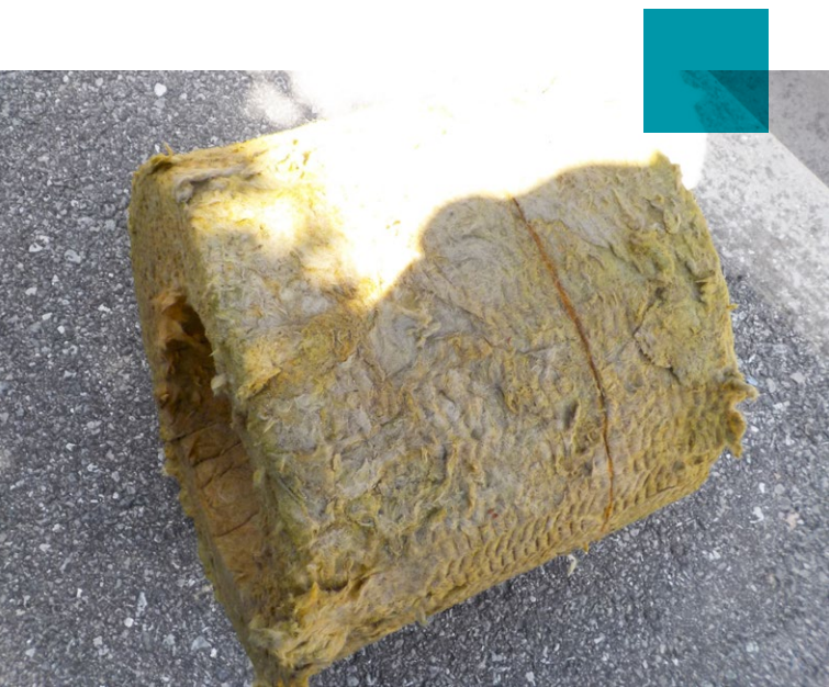
Isolation ROCKWOOL WR-Tech après trois ans de test entre 120 °C et 140 °C.
